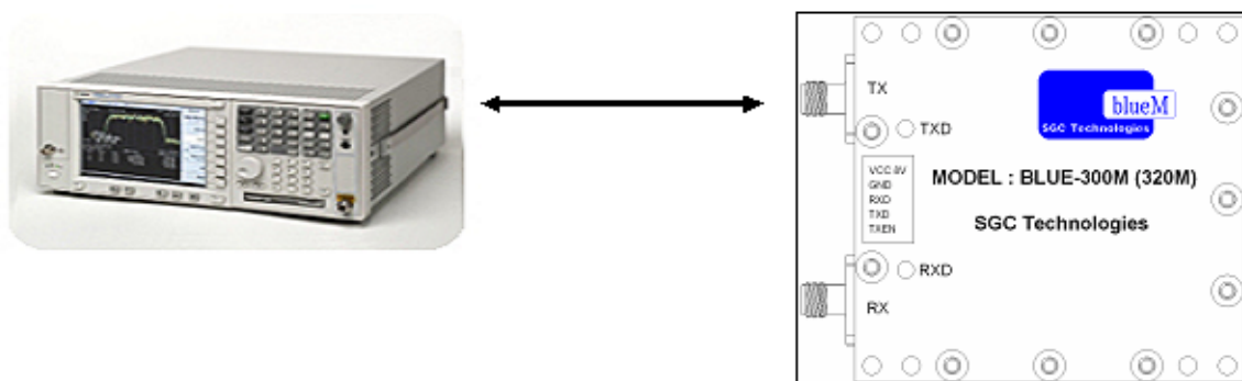
그림 4. 점유 주파수 대역폭 측정 장비 구성도
